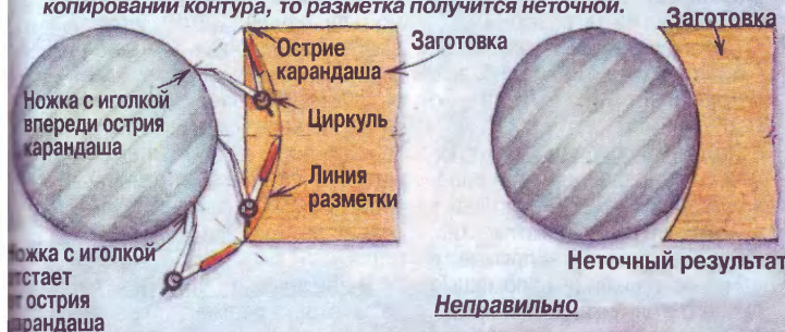
Рис. 2. Разметка стеновой панели. Для подгонки ее к неровной поверхности панель устанавливается приблизительно на расстоянии 10 мм от задающей поверхности. Разметка профиля проводится циркулем с раствором, установленным на размер «Х» (расстояние между ребром панели и нижней точкой самой глубокой выемки плюс 10 мм).
