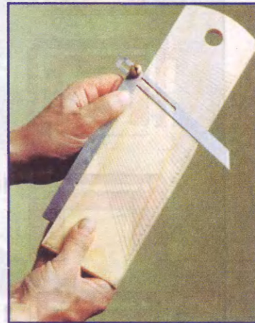
Фото 2. Судостроительная «дощечка углов». Самодельная дощечка с прорезанными на ней 46 линиями с шагом через 1° облегчает считывание углов, замеренных складным угольником, и последующую установку пилы в нужные положения.
